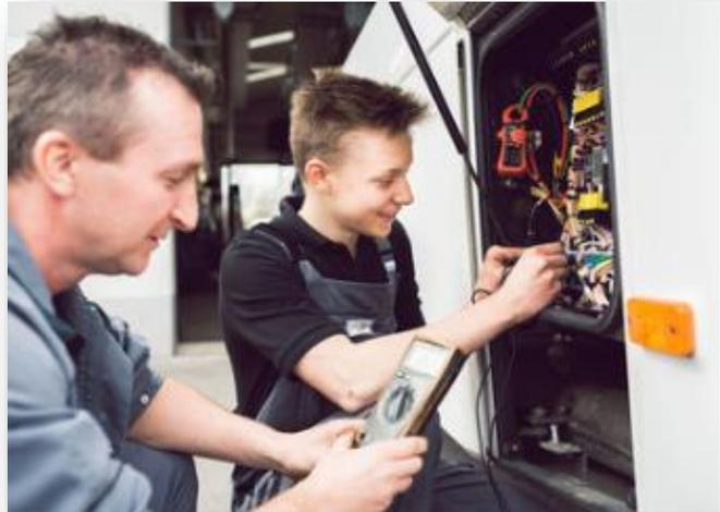
Im Team oder allein baust du schadhafte und unbrauchbar gewordene Teile an unseren Bussen aus und ersetzt diese. Du nimmst Einstellungen am Motor, an den Bremsen, der Lenkung oder Lichtanlage und vielem mehr vor. Dabei arbeitest du mit elektronischen Mess- und Prüfgeräten ebenso wie mit Schraubendreher, Zange und Hammer und anderen technischen Werkzeugen & Hilfsmitteln
